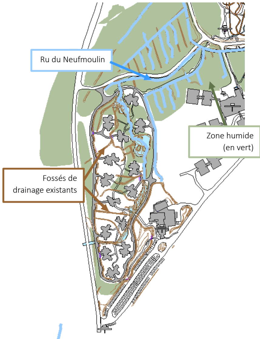
FIGURE 9 : CONTEXTE HYDRAULIQUE DU BV-P04- HOTEL CITE SUSPENDUE
