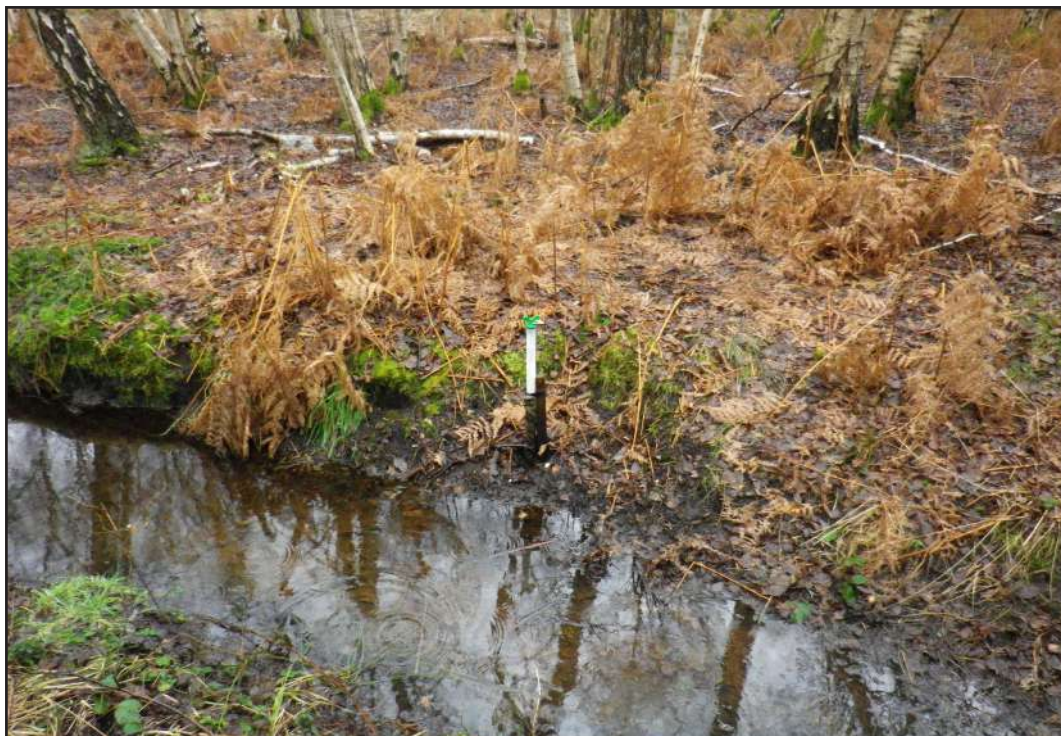
Photo 1 : Piézomètre n°1 (Fossé de débordement du bassin pluvial 1)
