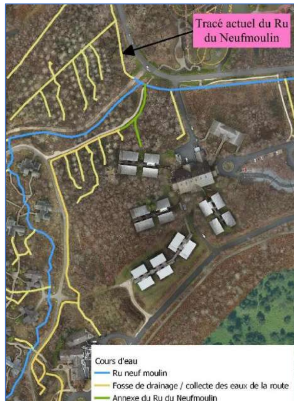
FIGURE 4 : FOSSES DE DRAINAGES EXISTANTS A PROXIMITE DU PROJET D'EXTENSION DU H3H (SOURCE : SITRARIVE)
