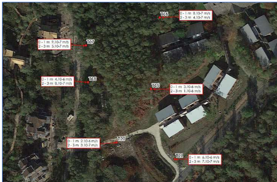
FIGURE 2 : IMPLANTATION DES ESSAIS DE PERMEABILITE DANS LA ZONE DES HOTELS (SOURCE : GEOTECHNIQUE APPLIQUEE IDF, NOVEMBRE 2022)
